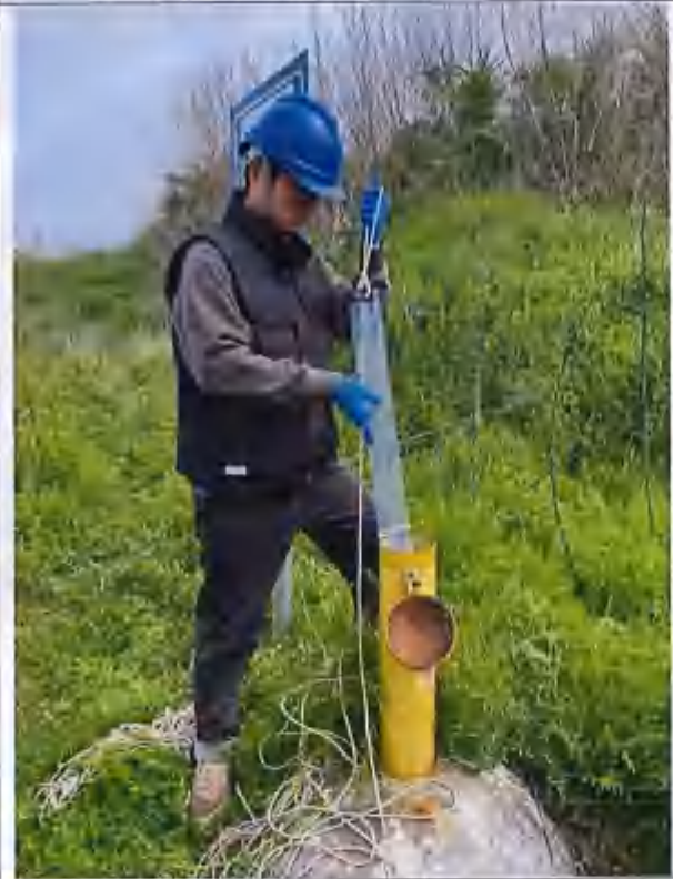
(4) 地下水现场采样照片
